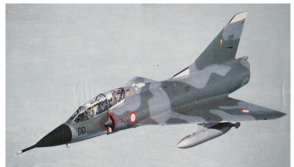
« MIRAGE III B » du C.I.F.A.S. équipé d'une perche de ravitaillement en vol pour contacts secs.
